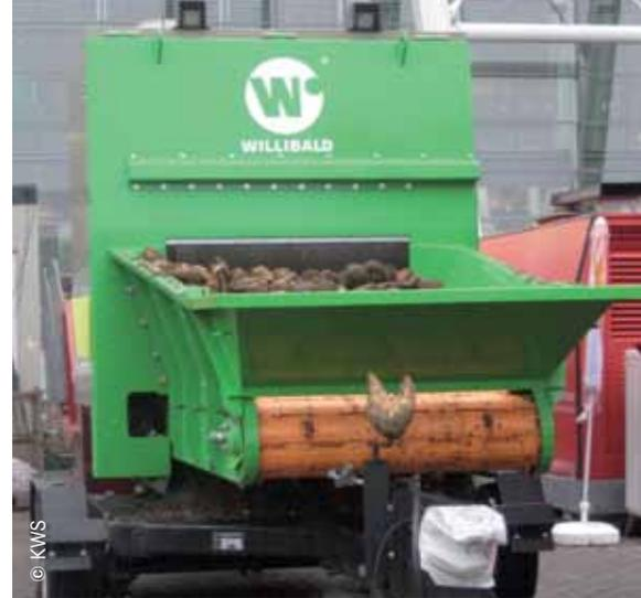
Abb. 21: Willibald-Schredder mit hoher Durchsatzleistung und „Steintoleranz“
