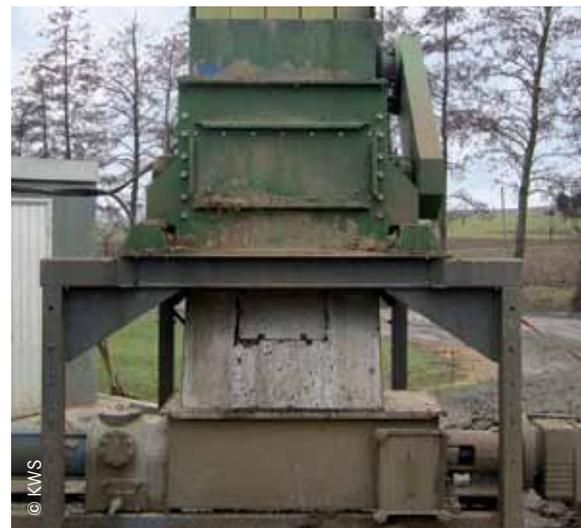
Abb. 22: Zerreißer mit hohem Durchsatz und direkt angeschlossener Pumpe, allerdings steinempfindlich.
